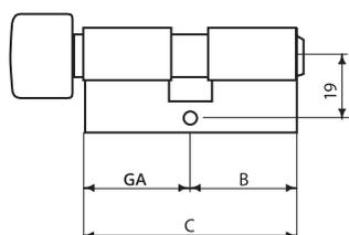
Размеры для личинки типа кнопка-ключ, приводимые GA / B.
